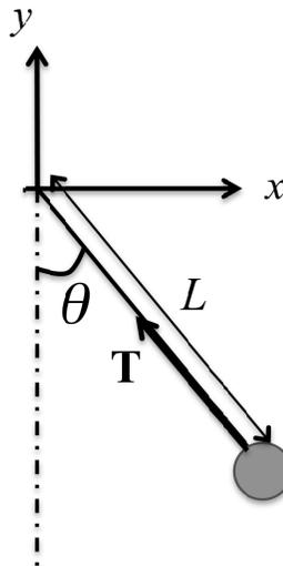
3. Realice una determinación experimental de la aceleración de la gravedad  $g$  realizando mediciones del periodo de oscilación  $T$  de un péndulo como función de la longitud del brazo del péndulo  $\ell$ .
